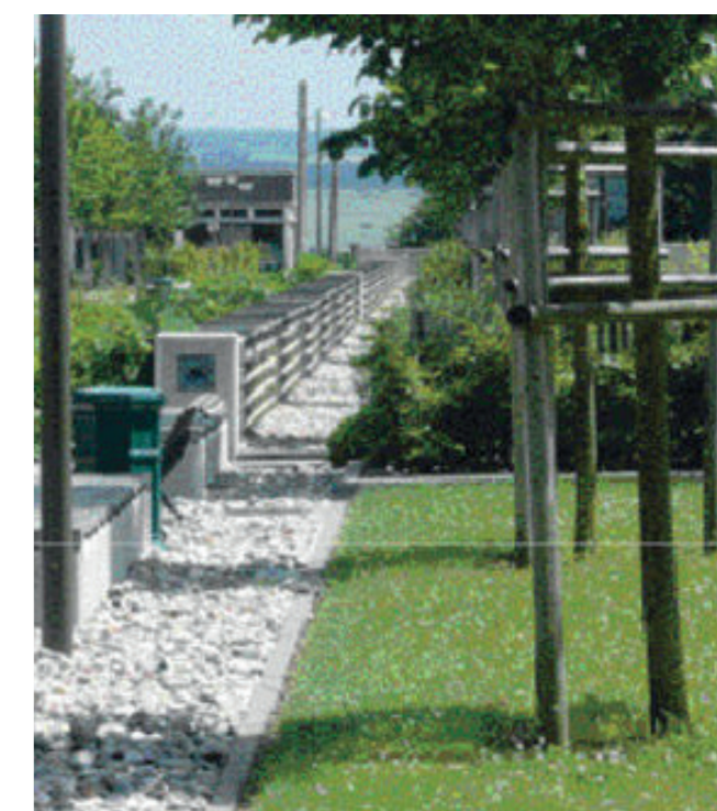
Exemple de tranchée d'infiltration
